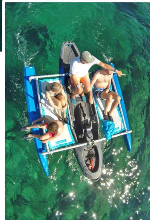
**PEDAYAK TRIO** est un trimaran composé d'un **PEDAYAK** et de deux flotteurs stabilisateurs maintenus avec une solide structure tubulaire, montable et démontable en 5 minutes.
